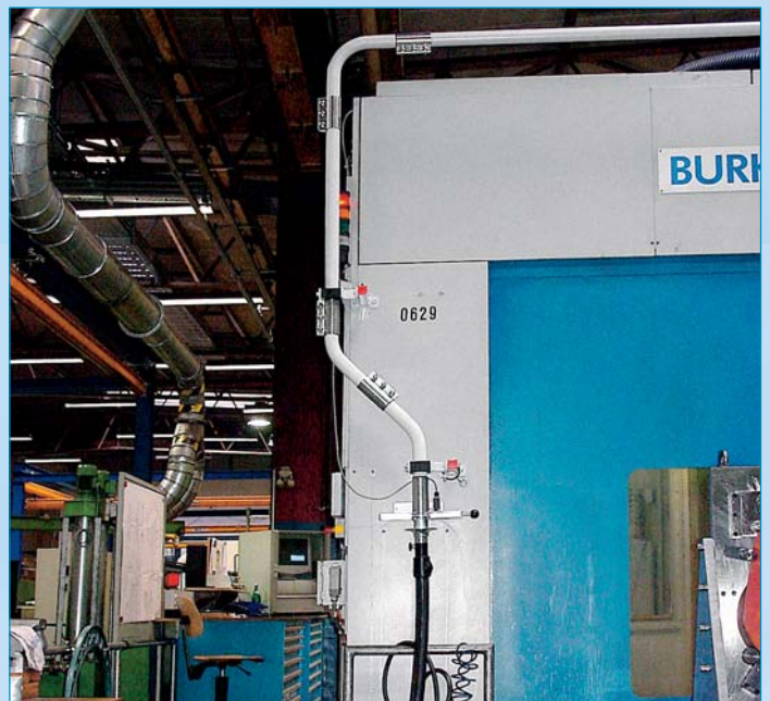
Bild links: RI 751 mit Ringler-Rohrleitungssystem und 2 Saugstellen Bild rechts: Saugstelle 2. Bei Abnahme des Saugschlauches schaltet das Gerät automatisch ein. Nach den Reinigungsarbeiten werden die Späne + KSS automatisch in den Späneförderer entleert.
