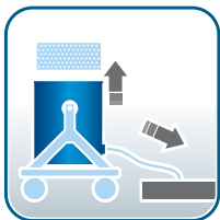
Entnahme des Abtropf-Siebkorbes, Rückführung der Flüssigkeiten in die Maschine über den Füllstandskontroll- und Entleerschlauch durch Gefälle
