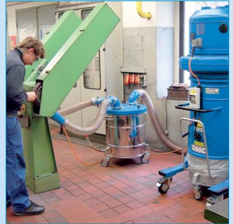
RI 334 mit Edelstahl-Nassvorabscheider zum sicheren Abscheiden von Stäuben mit Funkenflug an 2 Bandschleifern.
