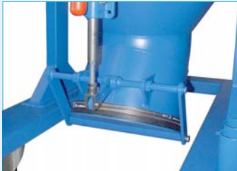
Sammelbehälter 100l Fassungsvermögen mit Entleerklappe und Handhebel-Verschluss
