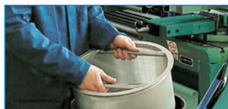
Siebkorbentleerung mit Späne- und Flüssigkeitstrennung
