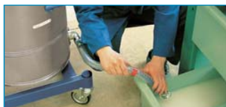
Manuelles Ablassen von Kühlschmierstoffen
