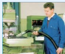
Handabsaugung von Spänen an Werkzeugmaschine
